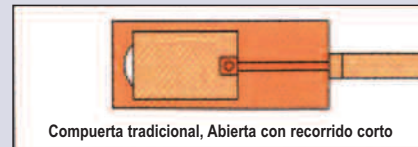
Compuerta tradicional, Abierta con recorrido corto
